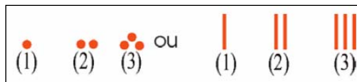
Figura 9.4 – Indicação de metros de uma mira estadimétrico
