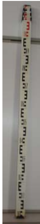
Figura 9.3 – Mira Estadimétrica (Régua de madeira, alumínio ou PVC, graduada em metros, decímetros, centímetros e milímetros)
