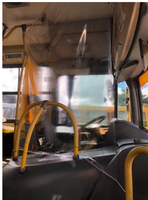
Figura 1. Barreira de proteção entre motorista e passageiros Fonte: G1 (2020)
