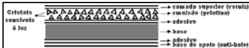
Figura 2.20. Estrutura de um filme preto e branco
