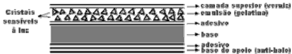
Figura 16. Estrutura de um filme preto e branco.
