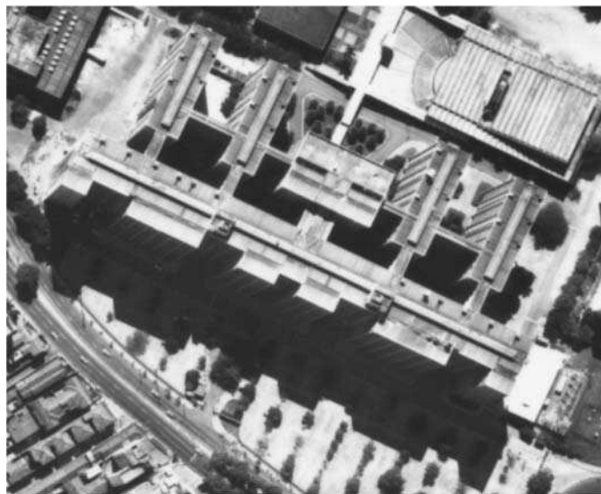
Figura 6: Em virtude da iluminação oblíqua dos raios de sol, os objetos produzem sombras, que podem se tornar desagradáveis por cobrirem parte relevante da fotografia (essa fotografia aérea é cortesia do Instituto Pereira Passos, da Prefeitura do Rio de Janeiro, e mostra o pavilhão Reitor João Lyra Filho, da Universidade do Estado do Rio de Janeiro, e parte do bairro de Vila Isabel).
